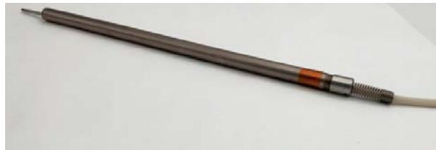
*Рисунок 1 - Внешний вид датчика линейных перемещений*
