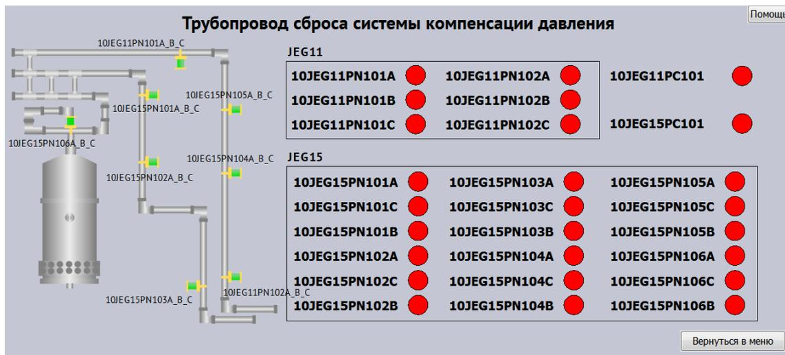
Рисунок 2. Видеокадр расчетных достоверностей датчиков трубопровода сброса системы компенсации давления
