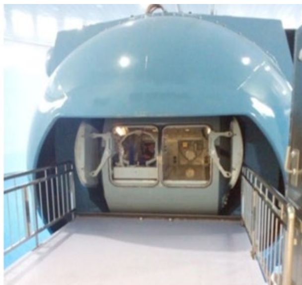
Рис. 2. Общий вид двухместной кабины со стороны входа. Люки открыты.
