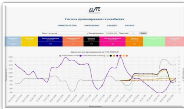
Рис. 8 Экран программного модуля прогнозирования потребления газа.
